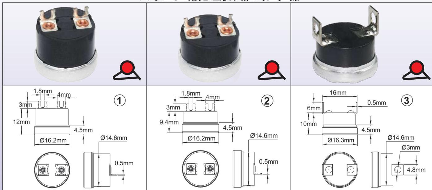
这碟形温控器适用于电线末端的安装，带小尺寸的焊合端子和铝形杯状件。能填灌硅胶和或环氧树脂胶。温度上升时温控器打开。
