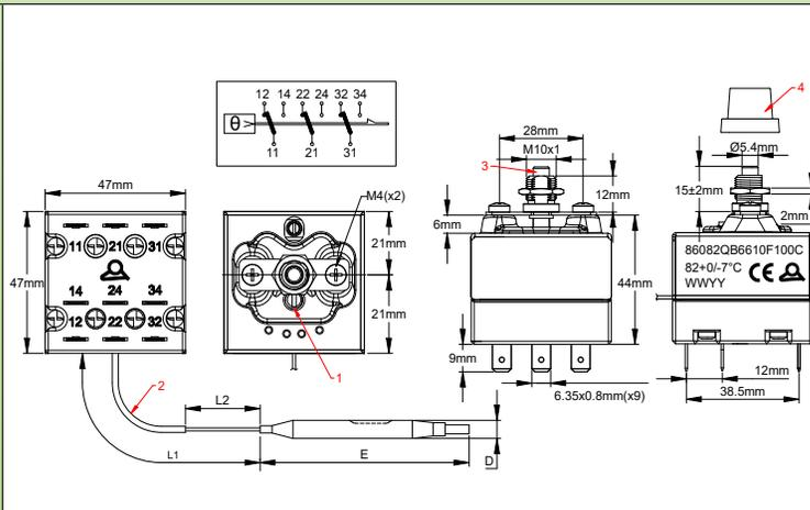
1: 密封胶 2: 套管 3: 手动复位按钮 4: 手动复位按钮帽盖
