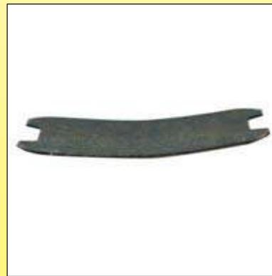
在很多应用中，需要生产一个带快捷操作的双金属，在给出的温度中形状产生突然的改变。为此，碟形的双金属片是凸起的，并形成了一个圆顶状。温度的改变会引致能量积聚在那里，于是在一个特定的温度，猛然从凹形变成凸形。对成份、厚度、冲压的深度和热处理都有一个非常严格的筛选，以达到精确、稳定及反复的操作温度。
