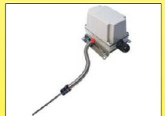
这是最常见的远程测量和温度控制器。毛细管长度可以达到3米，但是由于在毛细管里的液体量，会带有一个明显的偏差。
