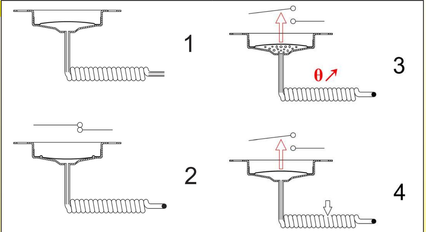
在沸腾式失效安全系统里，膜盒液体膨胀式探温组件的波纹膜盒由2个碟片组成，其中一个**是凸起的**。
