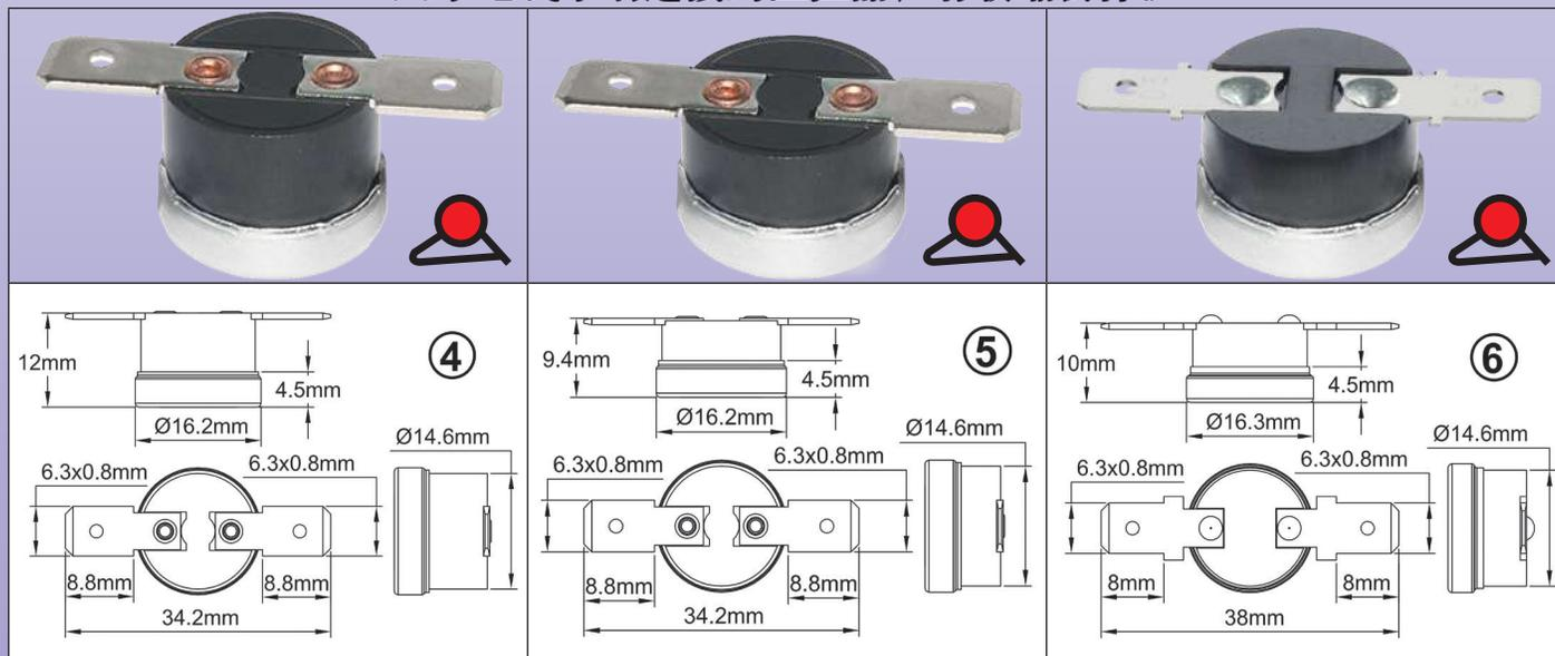
防冻温控器，在双重收缩管的情况下用于安装在发热线的末端，带有 6.3×0.8 水平快插端子，用于固接连接器或焊合。铝制的温度感应杯状件，温度上升时触点打开。
