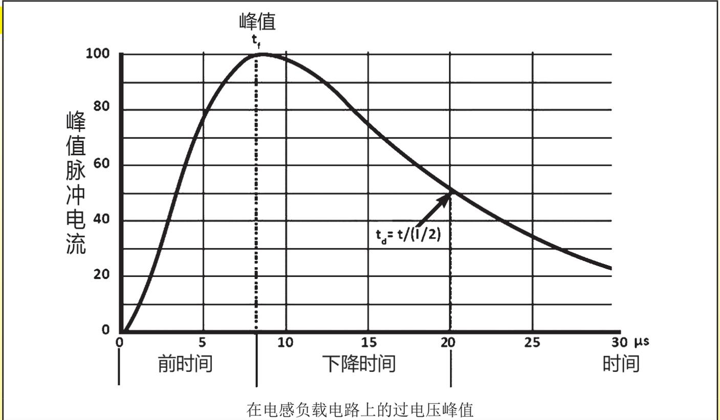
当一个开关断开一个感应负载，在开关的触点电路会产生一个相当高的逆电动势(反电势)。反电势越高，对接触点的损坏就越大。
