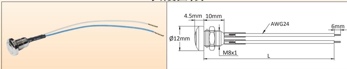
用于手动复位的接线开关。在安装板上需要一个直径8mm的孔。电线长度100mm。其他长度可按要求供应。
