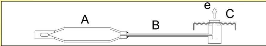
球管和毛细管温控器有一个闭合的组件叫“膜盒液体膨胀式探温组件”。
