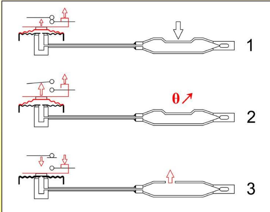
在这些系统里, 在室温密封膜盒液体膨胀式探温组件后, 在球管上做了一个小的凸起, 导致波纹膜盒的一个人工的膨胀(1)。通过在负温度(-20, -30°C)下密封膜盒液体膨胀式探温组件也可以产生同样的功能。通过这些方法, 波纹膜盒在室温以下的温度继续缩小。
