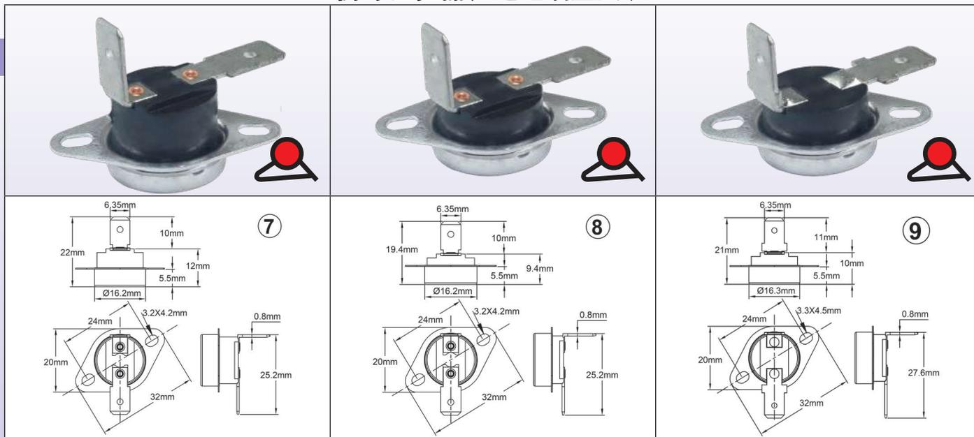
**防冻温控器，在接合点或连接盒通过墙壁安装，6.3×0.8快插端子。**铝制的温度感应的扩展型杯状件，温度上升时触点打开。
